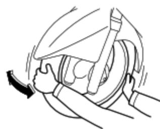
بررسی بلبرینگ چرخ ها
